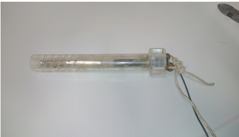
Abbildung 29. Selbstangefertigte Schutzhülle des N 2 O-Mikrosensors.
